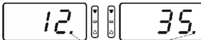
Горящая десятичная точка, признак того, что масса отображается с точностью до 1 грамма
